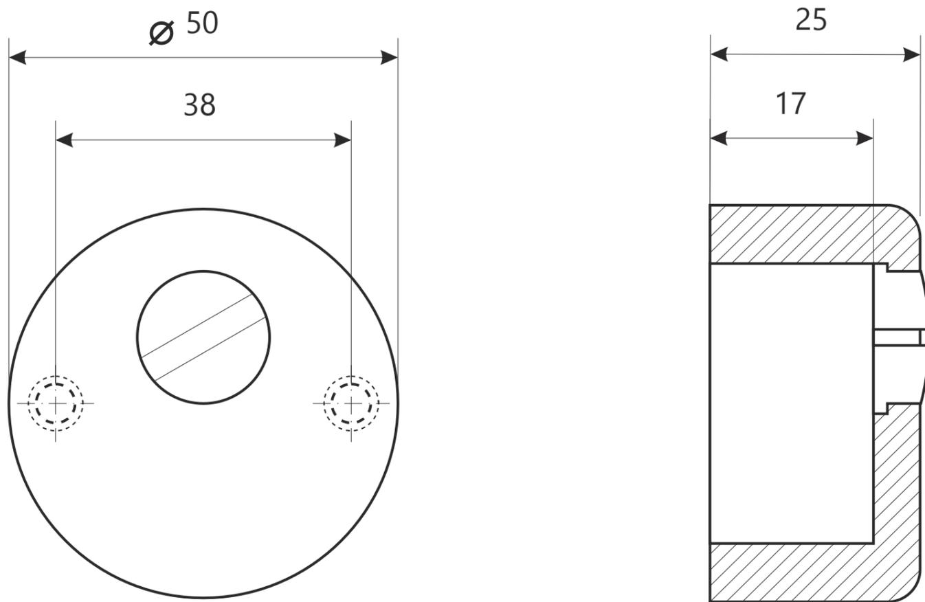
**Винт крепления броненакладки М6, 2 шт.**
