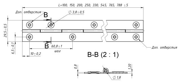
1. Дополнительные отверстия прокалывать, если расстояние от торца до отверстия более 30 мм
